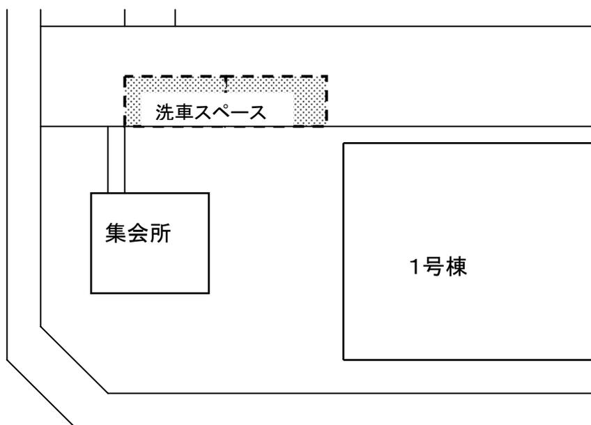
従来、当マンションでは東面の歩道で自動車を洗車される方が多くありました。東面の歩道は通行者が多いために通行の障害になること、洗車で使用する水に起因すると考えられるカラーアスファルト舗装の地盤沈下があることなどが、課題になっていました。そこで『外構舗装等改修工事』の概要で既にお知らせしましたが、集会所前に2台分の洗車スペースを設けました。図の「洗車スペース」(インターロッキングブロックの色を変えて囲っています)の位置で、その下にコンクリート基礎を施工して沈下対策として、また、洗車で発生した汚水が直接、公道との境にあるU字溝に流れ込まないようにオイル・トラップを設けています。
