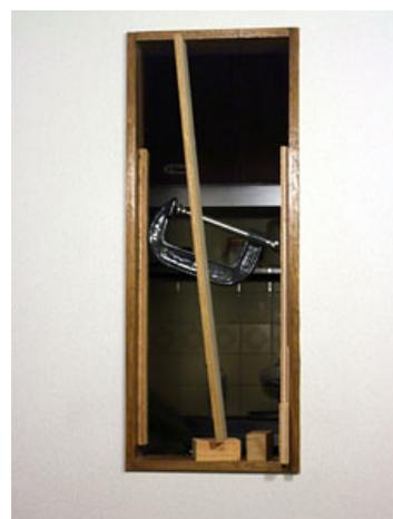
⑥開口部枠の接着状況(内寸法は高さ 62cm、幅 22cm。板は幅 90mm、厚さ 14mm。)
