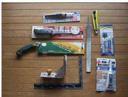
左上から：下地探しツール、ボードソー、ノコギリ、直角切りアダプタ、金尺
