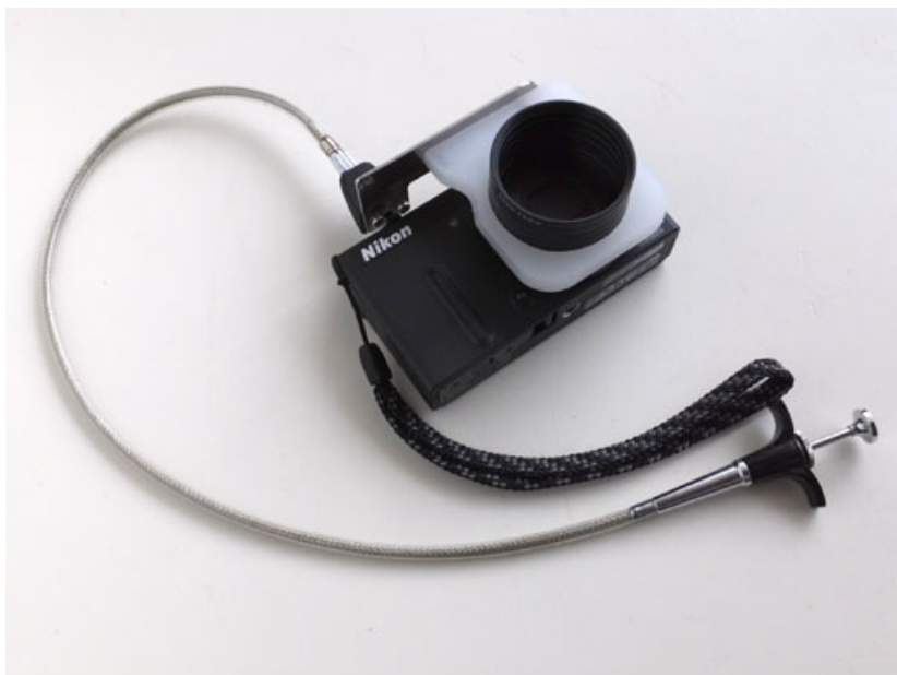
COOLPIX P330 に自作レリーズブラケットでケーブルレリーズ取り付け
