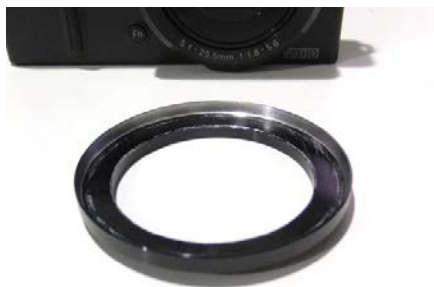
ステップアップリング 43-52mm の 52mm のメネジ側を削った状態
