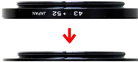
ステップアップリング 43-52mm の加工（イメージ）
