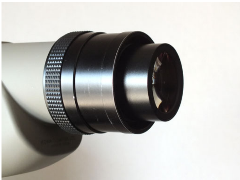
TSN-DA1 のインナーチューブより TE-14WD が突出した状態
