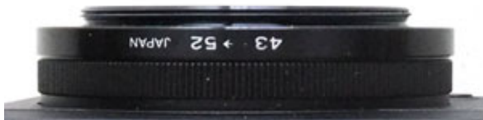
[改造後] 加工したステップアップリング 43-52 を取り付けたリング部
