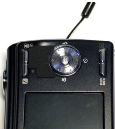
ブレ防止機能の誤操作防止用のスポンジシート
