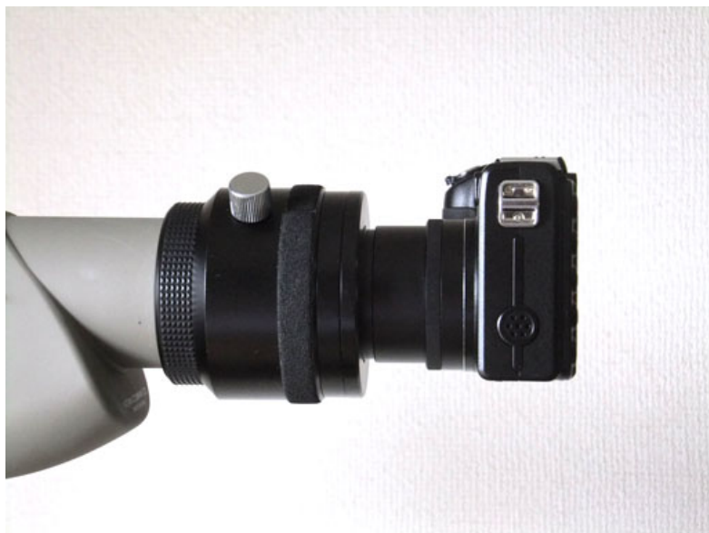
TSN-DA1 のインナーチューブにアウターチューブを使ってカメラを取り付け
