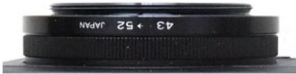
[改造後] 加工したステップアップリング 43-52 を取り付けしたリング部
