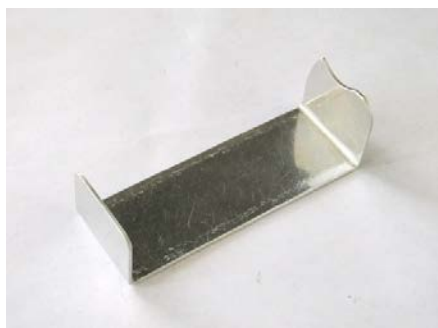
アルミ板を曲げ加工（左右をペンチの先端で曲げて剛性をアップ）
