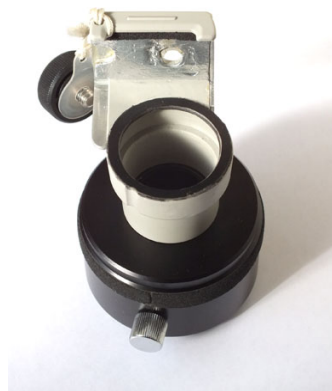
UR-E3改とアダプターリング TSN-AR28 を取り付けたア ウターチューブ
