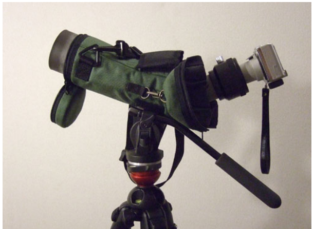
FinePix F31fd と TS-613 のデジスコ ビデオ雲台 700RC2 とビデオ三脚 756B (Manfrotto) の組み合わせ
