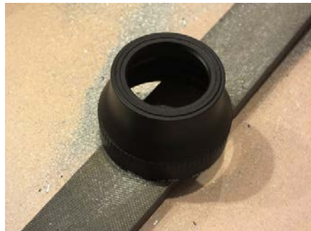
UR-E20 のカメラ側ネジを削る
