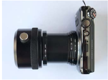
接続アダプター TSN DA-1 (アウトertube) を取り付けた状態
