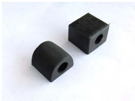
当たりブロックを半分にカットして角の部分丸く削る
