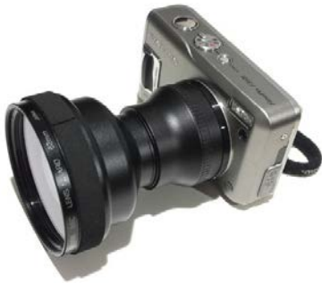
FinePix F31fd と 2倍のコンバータ TC-E2 の組み合わせ
