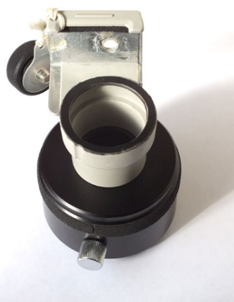
アダプターリング UR-E3 を改造した FinePix F11 用カメラアダプタ取付
