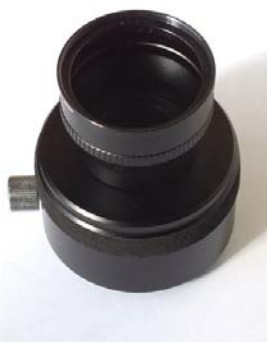
アダプターリング UR-E20 を改造した FinePix F31fd 用カメラアダプタ取付
