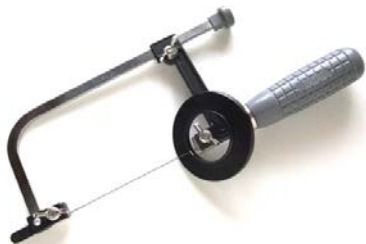
精密糸鋸で TSN-AR37 を切り抜き
