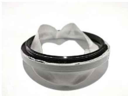
ステップアップリング 43 → 46mm の 43mm 側のオネジの先端を少しだけ、金ヤスリで削り、ステップアップリングの 43mm 側を上になるように平板の上に置き、UR-E20 の削った側を下側にして圧入して固定
