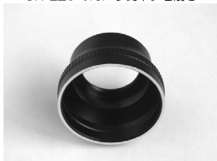
3mm ほど削った後、平板に置いた紙やすりの上で UR-E20 の金ヤスリで削った端面を仕上げ削り
