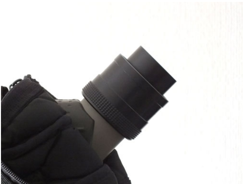
TSN-DA1 のインナーチューブを TS-613 に取り付けけた状態
