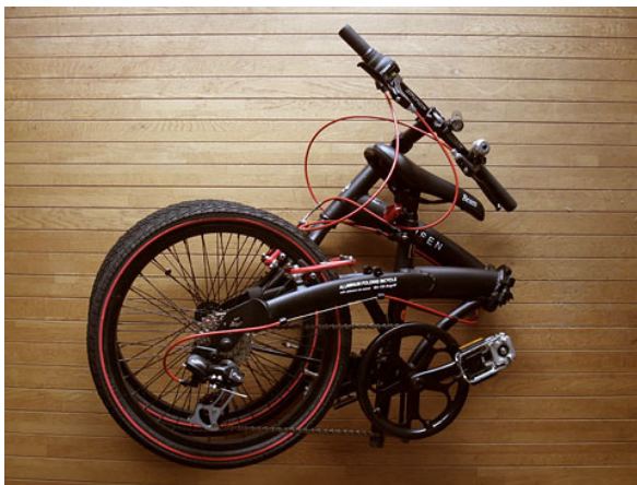
図 48 ハンドルステム BHS-22Q 使用時の折りたたみ状態
