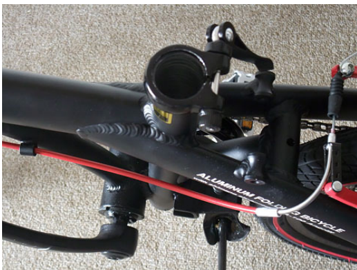
BA-100 の特徴となるメインパイプ、シートチューブ、シートステイ、シートステイブリッジの溶接構造
