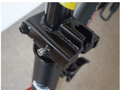
③ロックピン（写真の突出部） を押してフェイルセイフ解除
