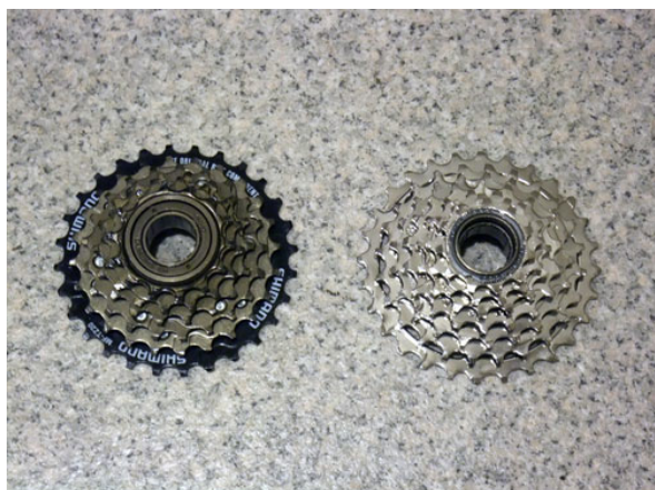
標準リアスプロケット MF-TZ20 (シマノ、393g) と LY-1107 (DNP、534g)
