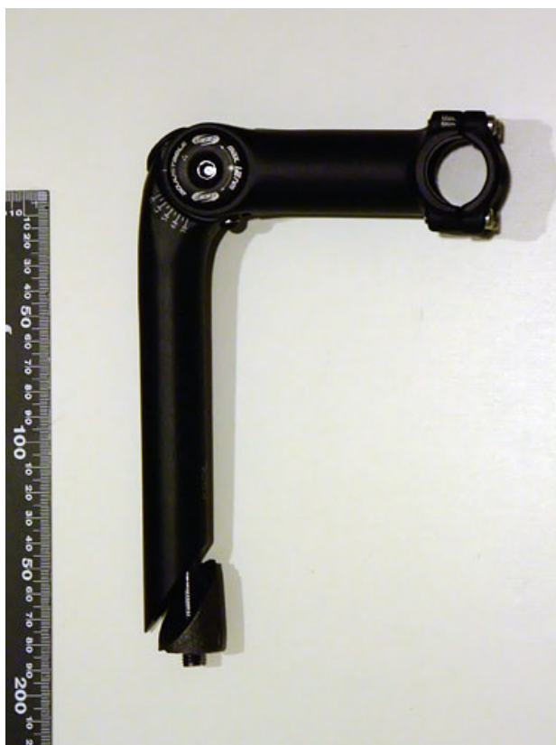
高さ：107mm (回転中心)、クイル径：25.4mm 突出し長：115mm、インサートライン：70mm 質量：約 445g、角度調整範囲は-20~90°
