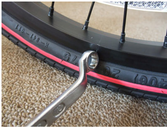
図 34 メガネレンチの先で継ぎ目対策
