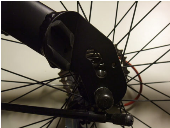
緩衝用ゴム (12g) の取付状況
