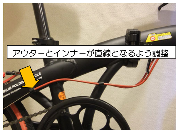
図 26 シフターを交換した状態
