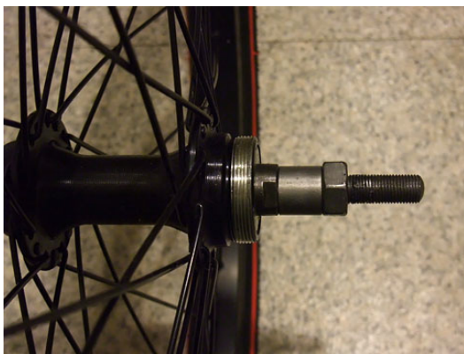
ボスフリースプロケットを外した状態
