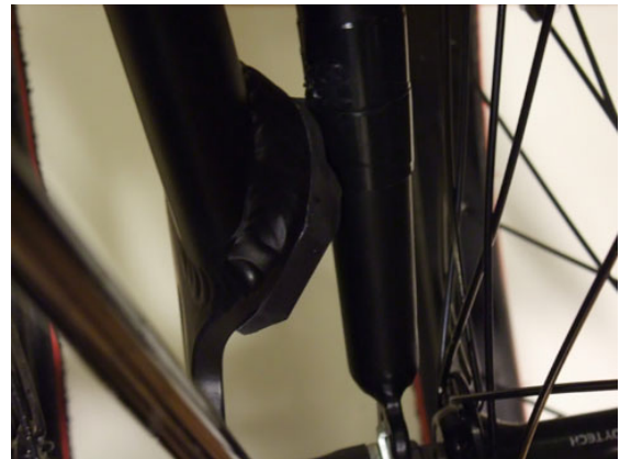
フォークと緩衝用ゴムの接触状況
