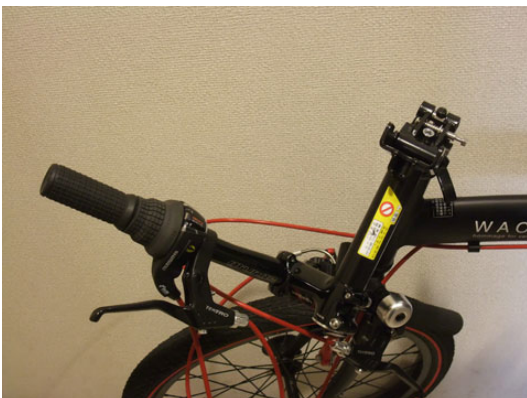
図 17 ハンドルの折畳み方向を変更 ステムの角度調整用ボルトを緩めて真直ぐにする必要があります。
