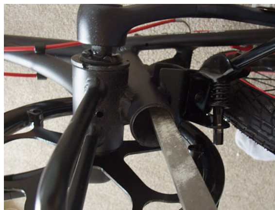
図 41 シートチューブ内面の平滑化
