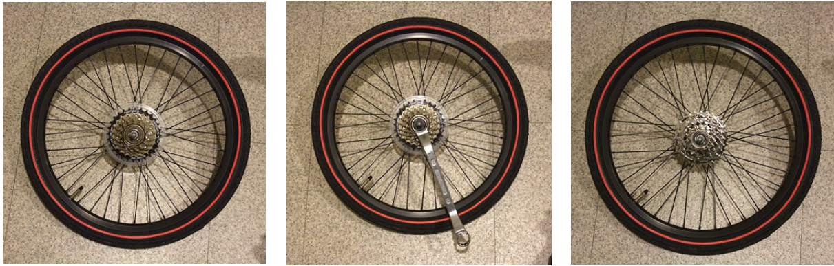
[スプロケット交換前] [スプロケット取外し作業] [スプロケット交換後]
