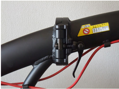
メインパイプの折畳み機構 (レバーは下向きがお勧め)
