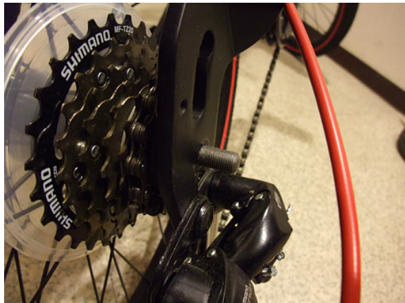
右側はナットを外し、タイヤを抜く
